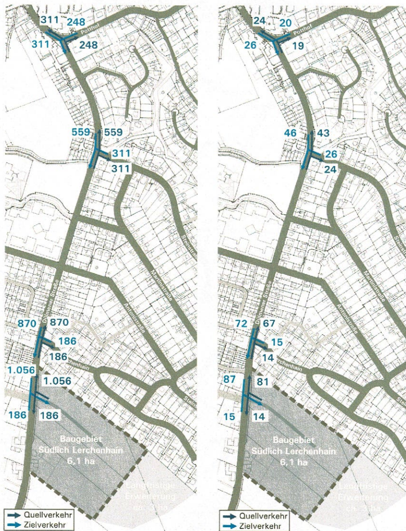
Abb. 11 Räumliche Verteilung der Neuverkehre im 1. + 2. Bauabschnitt in der Tagesbelastung [Kfz/24h] und der Spitzenstunde [Kfz/h]
